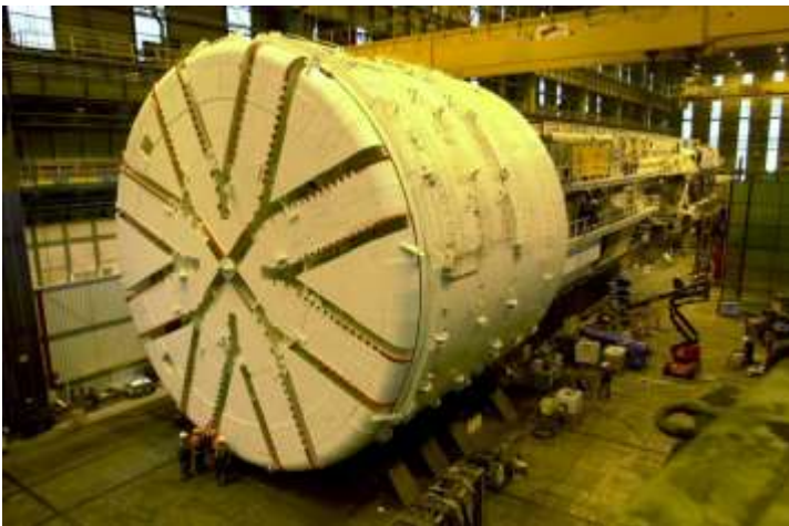
Figure 15 : Tunnelier NFM technologies, Thalys - Diam. 15 mètres (Source : NFM Technologies)
