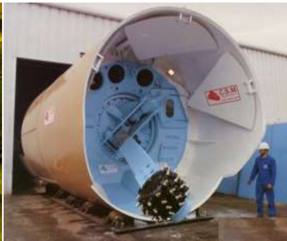
Figure 16 : Tunnelier CSM Bessac à attaque ponctuelle sous air comprimé (Source : CSM Bessac)
