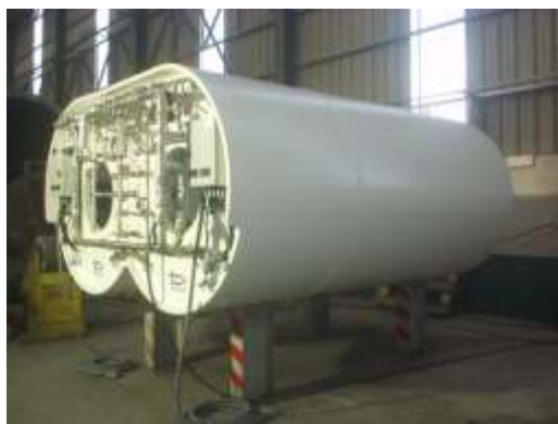
Figure 18 : Sas à 4 enceintes avant montage - Tech-Plus – NFM Technologies (Source : Jean-Claude Le Péchon)
