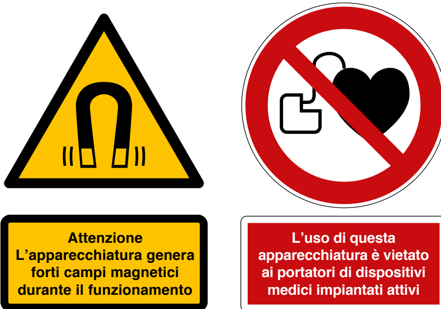
Figura 5.7 — Esempio di segnali di avvertimento e divieto
