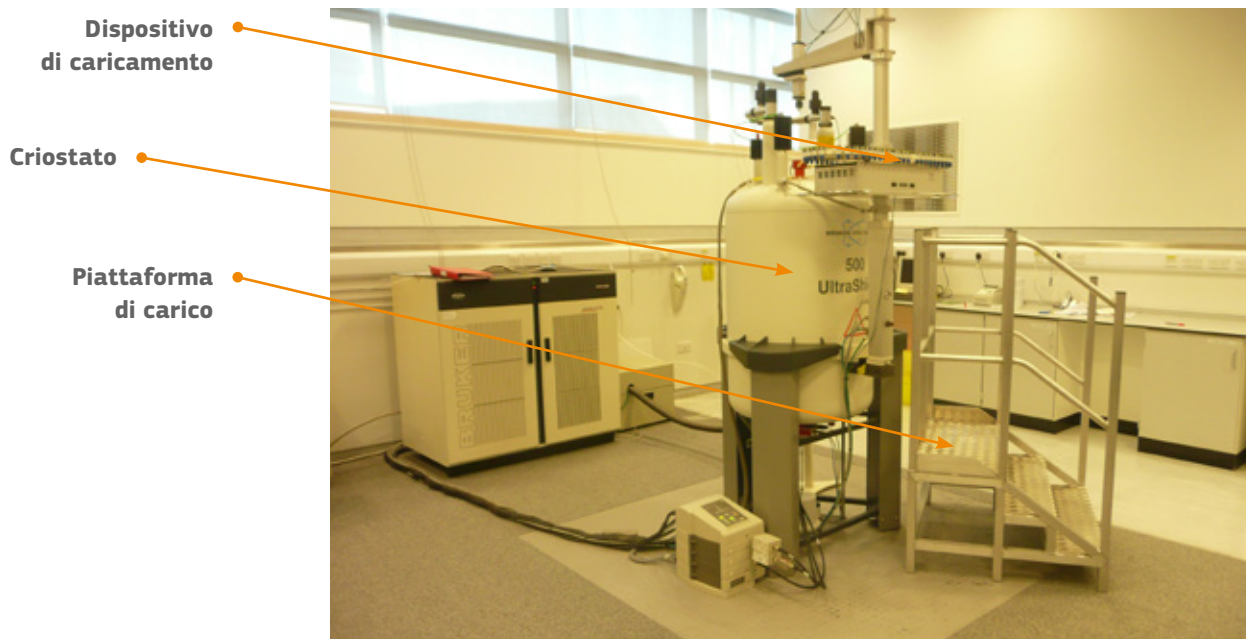
Figura 2.1 — Unità RMN, completa di dispositivo di caricamento e piattaforma di carico
