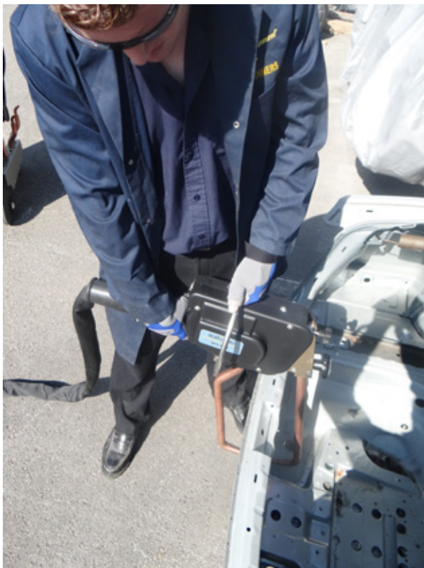
Figura 6.1 — Una saldatrice a punti manuale usata per collocare in posizione un nuovo pannello
