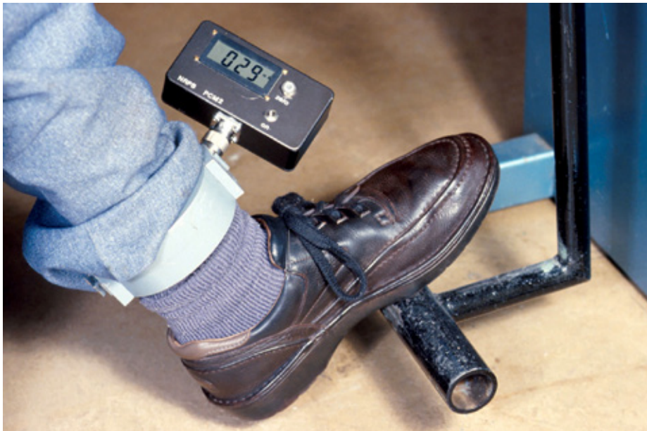
Figura C7 — Una pinza amperometrica usata per misurare la corrente attraverso gli arti quando si utilizza una saldatrice dielettrica a 27 MHz
