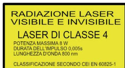
Figura 5.1 – Esempio di targhetta di classificazione di un LASER
