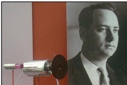
Figura 3.2 – Theodore H. Maiman e il primo prototipo di LASER funzionante
